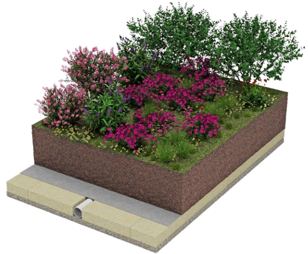
Schematische Darstellung Rockflow FloraSponge
