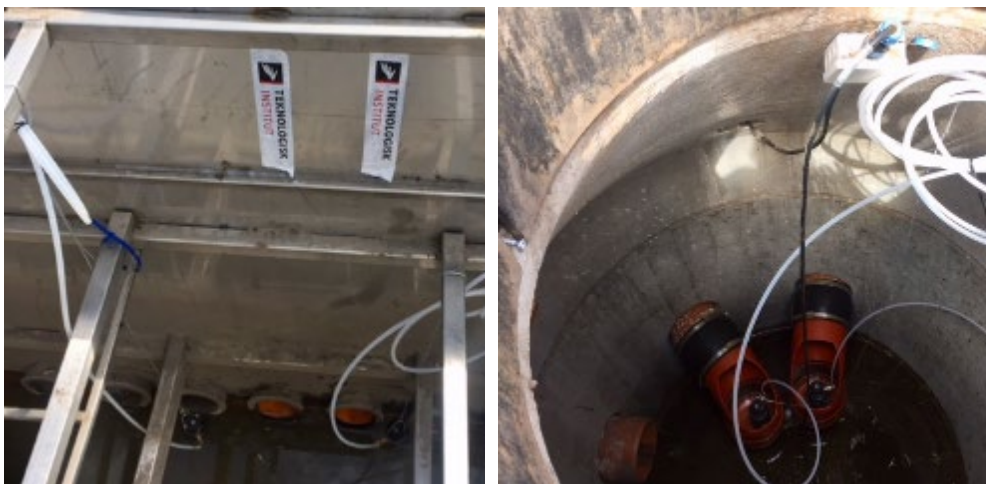
Prøvetagningsenheder (WW50) indsat i testanlægget på Risvang Allé hhv. ved indløb til filteret (tv) og i udløbsbrønden (th).
