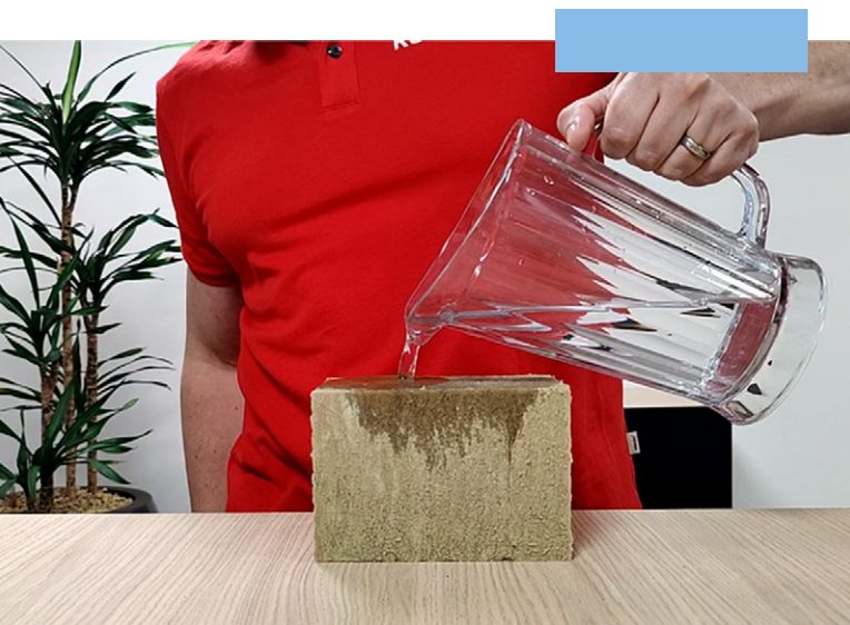
Rockflow-Steinwolle kann fast ihr gesamtes Volumen an Wasser aufnehmen.
